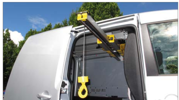
Seitliches Ausfahren zur Schiebetür
